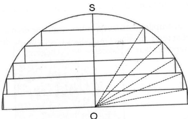
D'une façon générale, on partage le rayon [OS] en  $n$  parties égales. Chaque cylindre a une hauteur  $h = \frac{r}{n}$ . Il y a  $n-1$  cylindres dont les rayons  $r_i$  sont donnés,
